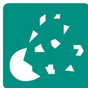
Magnete können beim Zusammenprallen in scharfkantige Teile splintern. Jeder Zusammenprall sollte deshalb vermieden werden.
